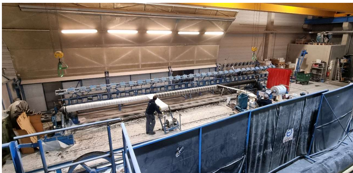
Abbildung 2: Wickelvorgang (Blick von Messstelle (B) bei Rovingspulen)
