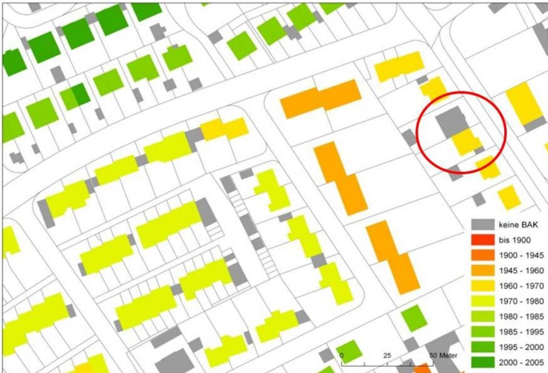
Abbildung 2-1: Zuordnung von Baualtersklassen
